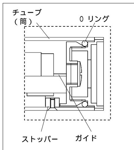
光源の片側とダミーネジの断面図
