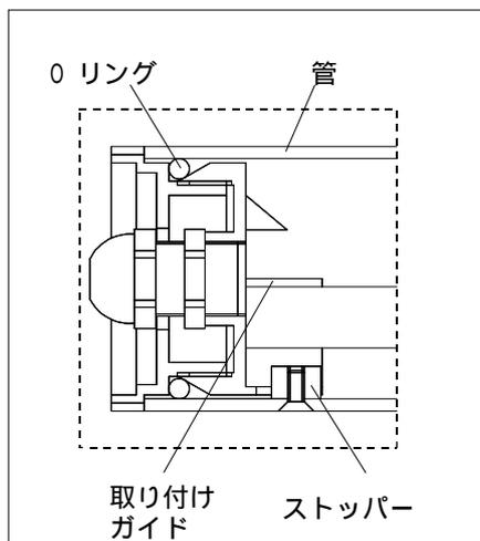
ケーブル側ネジ部の断面図
