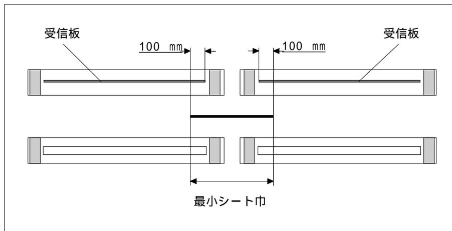
1. 最小シート巾の場合で内側から100mmの間にはシートが被さらないようにして下さい。
