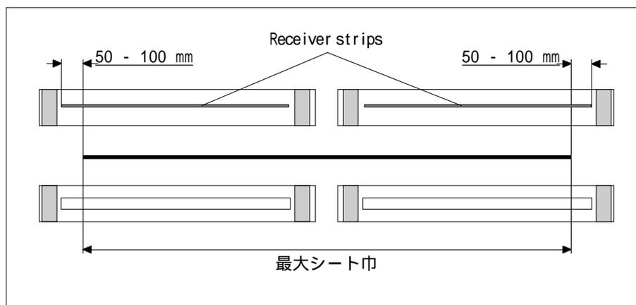
2. 最大シート巾で受信帯の外側から50mmから100mmの間にはシートが、被さらないようにして下さい。
